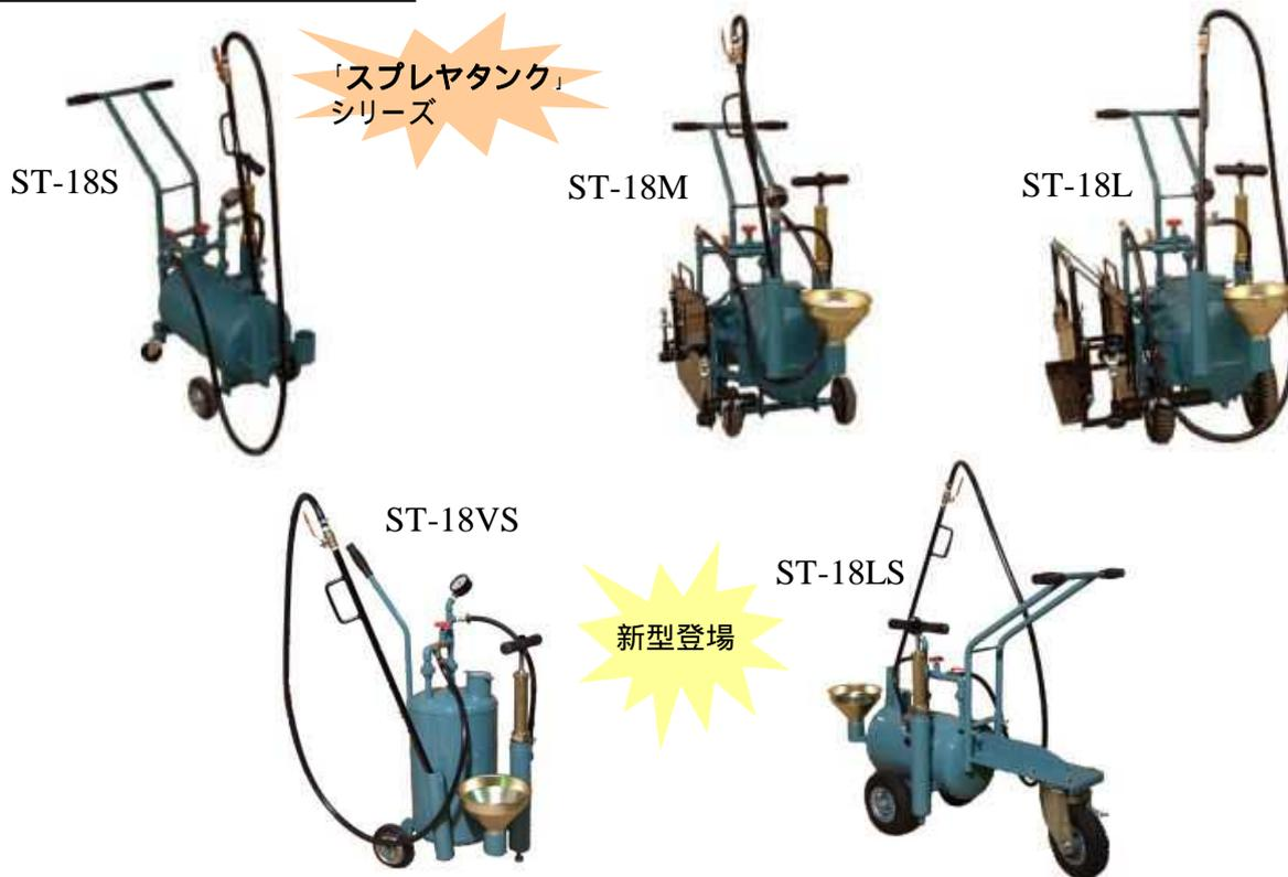
軽量小型アスファルト乳剤スプレヤ「スプレヤタンク」シリーズ。08年のグレードアップモデルチェンジで新型がラインナップしました。「ST-18VS」はST-18Sのタンク縦型モデル。横型より置き場所をとらず、軽量化がほどこされています。「ST-18LS」はST-18Sの大型車輪モデル。従来、大型車輪はダブル遮蔽板付のST-18Lしかありませんでした。ユーザー様のカスタムオーダーも多く、今回ラインナップインとなりました。全機種圧力エア洗浄。ハンドポンプ式。タイヤの簡易ブレーキ機能の改良、ハンドポンプ改良など、とても操作が簡単になっています。約0.1MPaで約2～3 L/minの散布量
